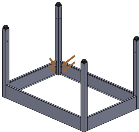
3. Aplicar as travessas trás e lateral consoante imagem (Aplicar 6 parafusos M6);
